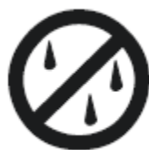
Figure D.1 – Symbole graphique normalisé utilisé sur les matériels
